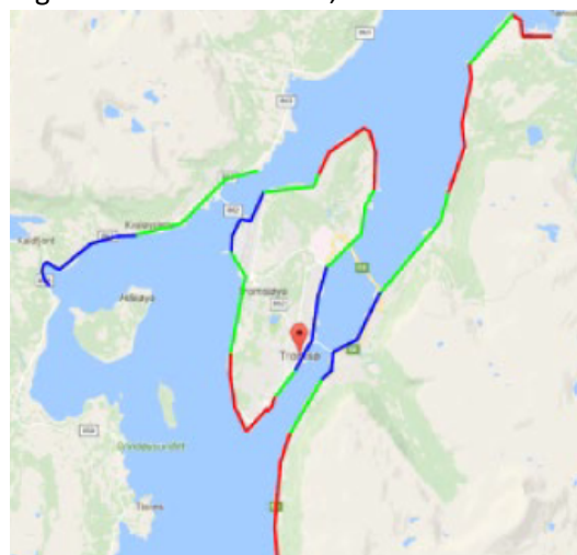
Figur 1 Omtrentlig anslag av ekstreme bølgeforhold i området: Blå, Hs = 1,0 m Grønn, Hs = 1,4 m og Rød, Hs = 1,8 m (COWI, 2017)
